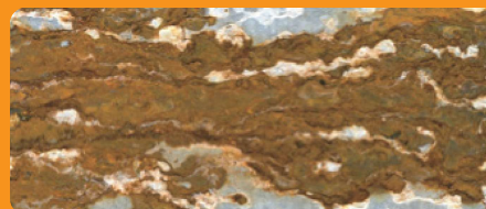
Konvenční galvanizace po 6 týdnech testu postříkem slanou vodou
