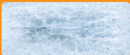
BUCON galvanizace po 34 týdnech testu postříkem slanou vodou
