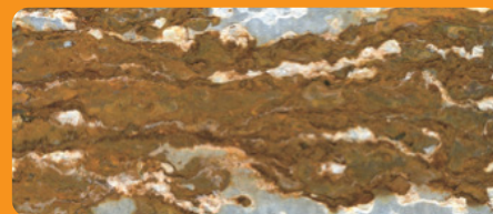
Übliche Galvanisierung nach 6 Wochen Salzsprühtest
