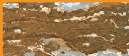
Galvanizado de BUCON tras 34 semanas en prueba con niebla salina
